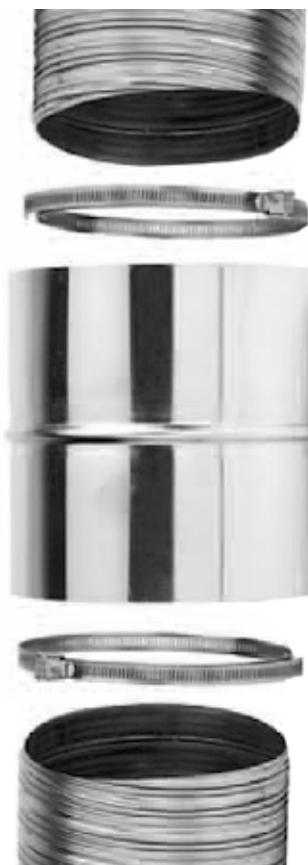
Condotto per intubamento flessibile marcato CE, di sezione circolare a doppia parete **Tecnoflex10** inox-inox, parete a contatto coi fumi in acciaio inox AISI 316L liscio. Idoneo per realizzare raccordi particolarmente tortuosi o per l'intubamento di canali esistenti con andamento verticale irregolare.
